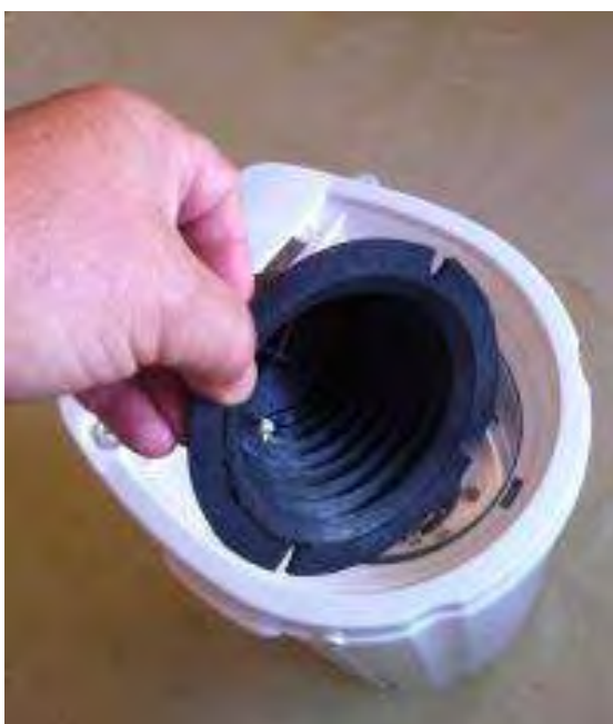
Рисунок 1. Внешний вид центробежного концентратора с плавающей постелью CCFB - Flexy-Bowl
