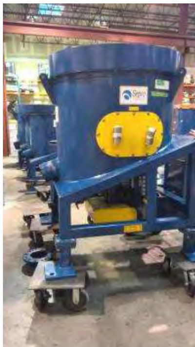
Рисунок 2. Центробежные концентраторы Falcon в сборочном цехе завода Serpo в Канаде
