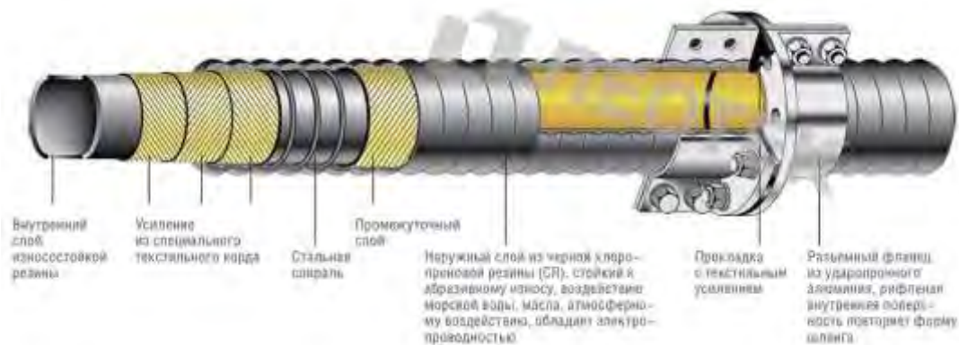
Рисунок 1. Строение абразивостойкого резинового (пульпо-) шлампровода
